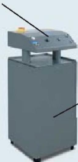
Il pannello di comando possiede un gruppo idraulico integrato che ne riduce notevolmente l'onere di installazione. Tutti e 4 gli elementi laterali si lasciano facilmente staccare per permettere interventi di manutenzione.
